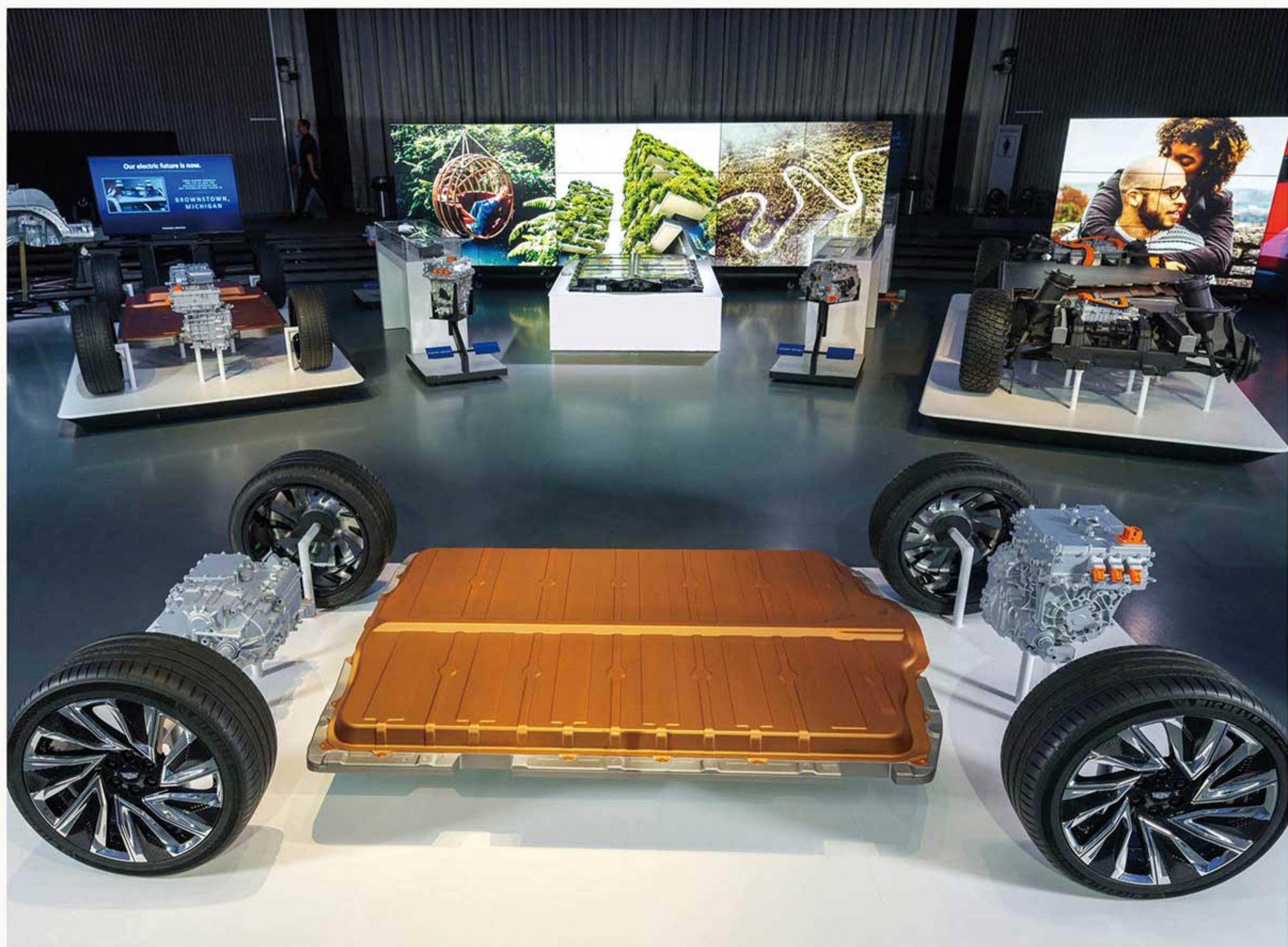
韓国LG化学が開発に関わったとされるコバルトの含有量が少ない蓄電池アルティウムの絶対性能は、400ボルトユニットの場合、レベル2のDC（直流）急速充電に対応し、最小50kW／hから最大200kW／hの急速充電機能を持ち、航続距離はフル充電で最大400マイル以上。静止状態から時速60マイルに到達するまでの加速性能は3秒以内。
