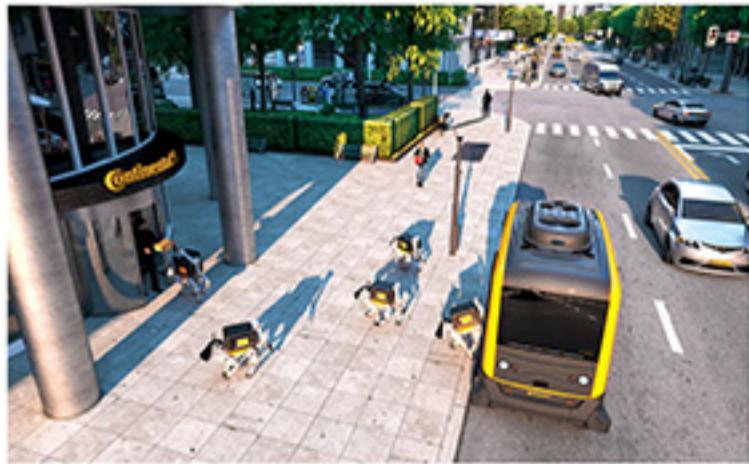
無人車両と配達ロボットを組み合わせた「コンチネンタル社」提案の小包配送の仕組み。配送地点までは自立型シャトル車両で移動。最終的に小包を届ける役割は大型の配達ロボットが担う。小包配送における完全無人化を可能にするソリューションのひとつだ。
